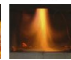
Pohľad do spaľovacej komory počas horenia
